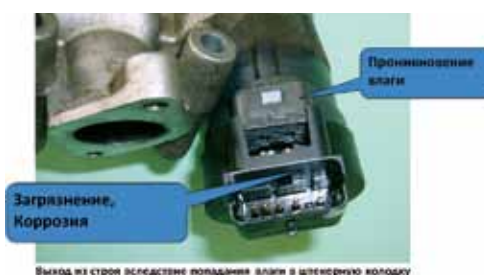
Выход из строя вследствие попадания влаги в шланговую колодку
