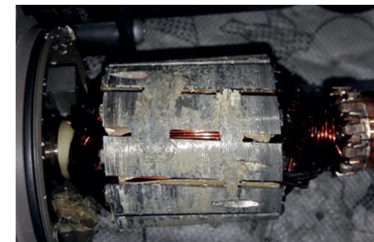
Рештки плавлення матеріалу на роторі
