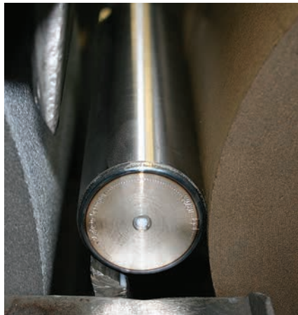
Шліфування для подальшого тривалого захисту від корозії
