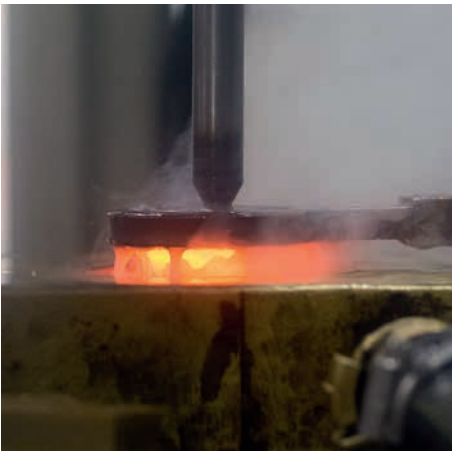
Індуктивне загартовування для тривалого захисту від зношування
