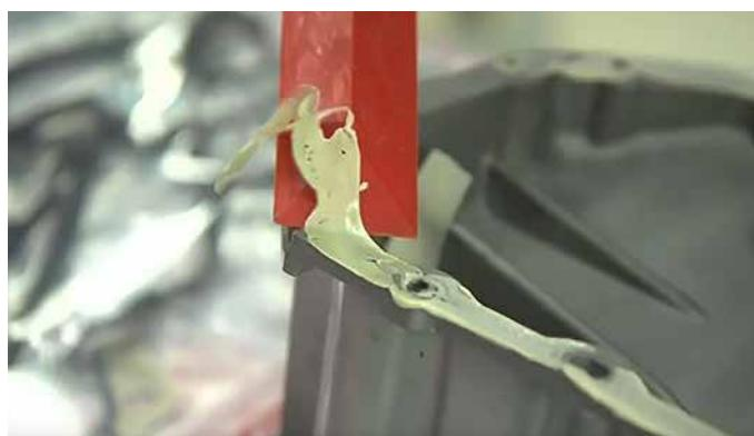
Также важно понимать, какие химические реакции происходят в процессе вулканизации. Обычно силикон начинает затвердевать при контакте с кислородом. Время реакции зависит от уровня влажности воздуха. Чем ниже влажность, тем дольше время вулканизации.
