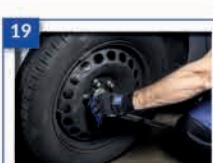
**19** При встановленні коліс не використовуйте ударний гайковерт. Первінно підтягніть болти колеса, а далі опустіть автомобіль і остаточно затягніть болти відповідно до значення моменту, рекомендованого виробником.
