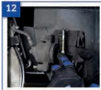
**13** Щоб запобігти пошкодженням, відведіть поршень гальмівного супорта, використовуючи спеціальне обладнання, після чого очистіть супорт гальма.
