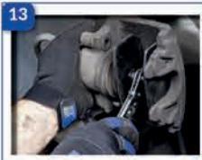
**14** Очистіть супорт та перевірте направляючі болти та захисні пильовики на стан зношування та пошкоджень.
