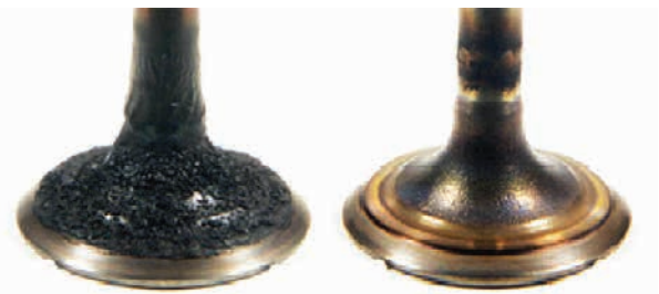
Загрязненный впускной клапан. До и после очистки.
