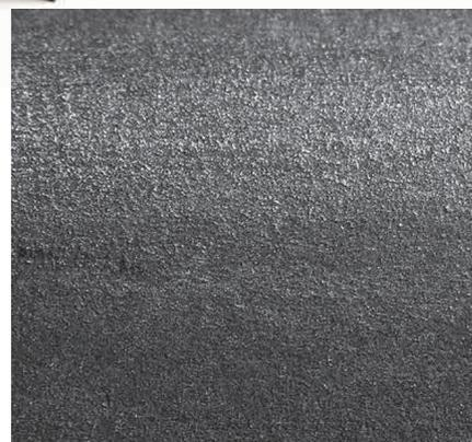
*Рис.2 Поверхность пружины перед дробеструйной обработкой.*
