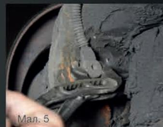
4. Після цього отвір і затискна втулка змащуються щоб запобігти передчасній корозії. Затискна втулка вставляється в отвір і потім датчик вставляється в затискну втулку, поки не торкнеться ротора. Завдяки зазору у підшипнику коліс і руху колеса відстань між датчиком і ротором регулюється автоматично. Датчики ABS від febi завжди постачаються у комплекті з втулками і мастилом. Таким чином, є все необхідне для заміни датчика.
