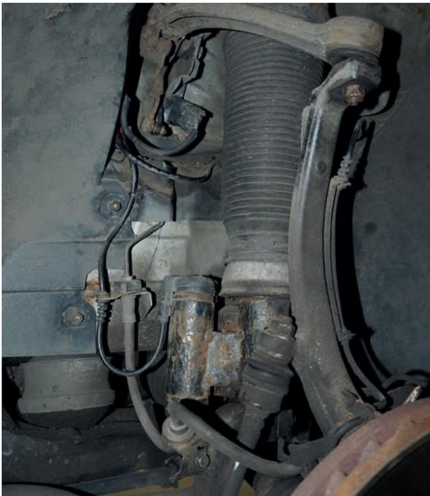
**Фото 3: Старий пневмомодуль, втрачено герметичність системи. (Ймовірно ресурс вже вичерпано остаточно, або ж він на грані). Варто перевірити підвіску, замінити всі зношені деталі**
