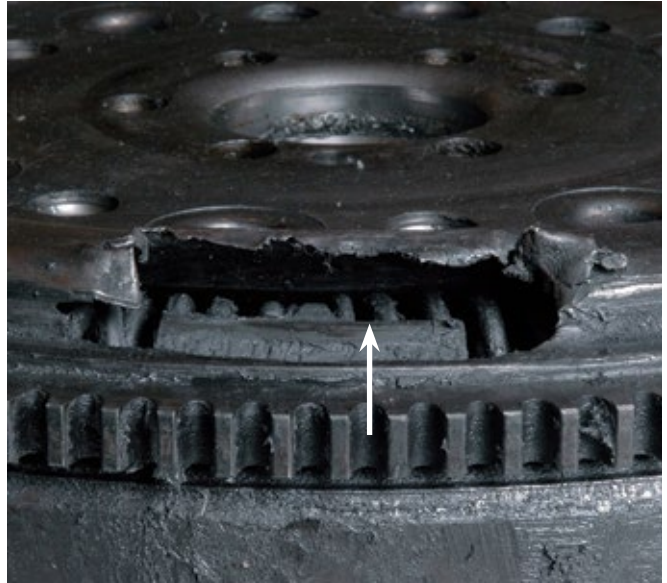
Об износе ПЕРВИЧНОЙ МАССЫ иногда свидетельствует появление смазки на поверхности. Такое разрушение является следствием недостаточных стартовых оборотов двигателя. Проблема в системе запуска, а не в маховике
