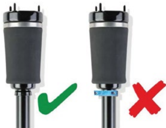
Иллюстрация 2. Удалить клипсу после монтажа
