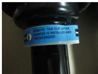
Иллюстрация 3. Наклейка на монтажной клипсе с указанием удалить клипсу после установки пневмомодуля и создания давления в системе.
