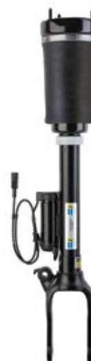
Иллюстрация 1. BILSTEIN B4 модуль пневмоподвески. Монтажная клипса
