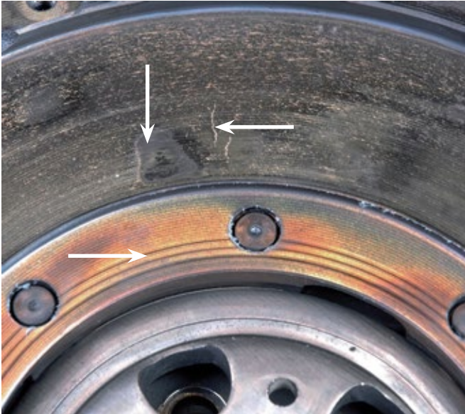
ПЕРЕГРЕВ вторичной массы в ДММ отчетливо заметен по цветам побежалости и тепловым трещинам
