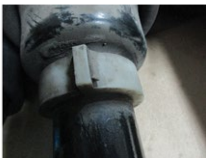
Иллюстрация 4. Некорректная установка! Мастер забыл удалить клипсу после монтажа.
