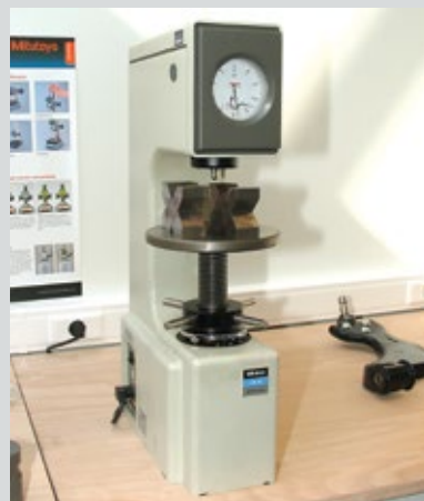
Твердомер Роквелла – машина для определения твердости материалов путем измерения относительной глубины проникновения твердого наконечника в исследуемый материал.
