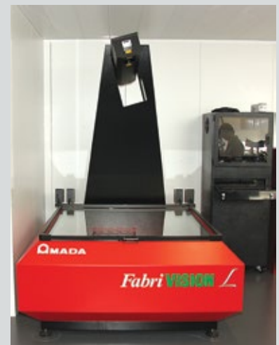
Лазерный сканер для копирования размеров прокладок.
