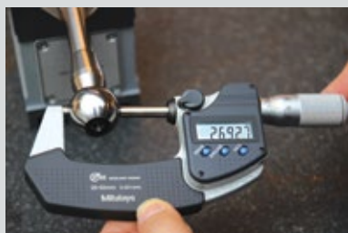
Высокоточный микрометр позволяет измерить диаметр шара (например, цапфы шарового шарнира) с точностью до тысячных долей миллиметра (микрон).
