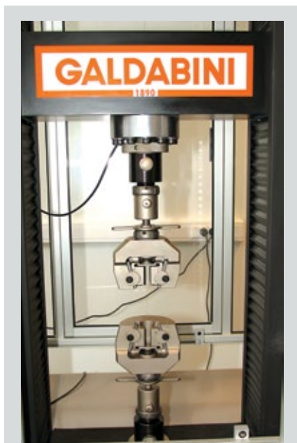
Сложные зажимы предназначены для испытаний на разрыв деталей подвески, рулевых тяг с наконечниками т.п.
