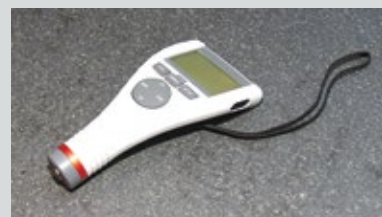
Толщина покрытия металлических деталей измеряется с помощью электромагнитного толщиномера с точностью до десятых долей микрометра (т.е. до 0,0001 мм).
