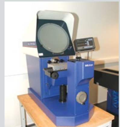
Профиль-проектор, используемый для копирования геометрических параметров мелких деталей.
