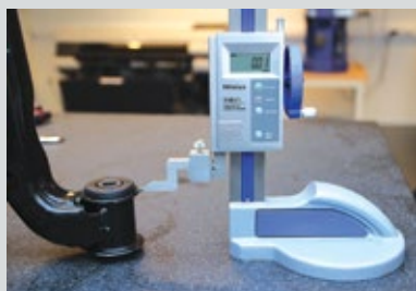
Высотомер по принципу действия схож со штангенциркулем – он измеряет точную высоту определенной точки над поверхностью, на которой расположена измеряемая деталь.
