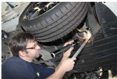
повреждения/износ сайлентблоков влияют на состояние/работу и износ амортизаторов.
