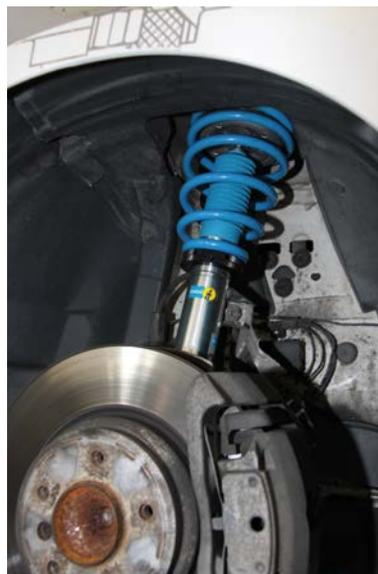
**10** Установленный амортизатор.
