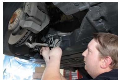
случае (BMW E90) датчик высоты положения ксеноновых фар. После установки амортизаторов следует вновь выровнять/отрегулировать ксеноновые фары.
