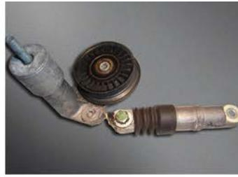
Ломается гидравлическое устройство натяжения ремня
