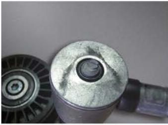
Ломается крепёжный винт натяжного устройства для ремня
