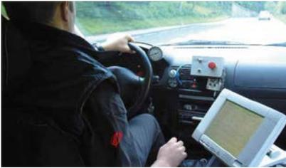
После завершения лабораторных тестов новых фрикционных материалов, вооружившись результатами комплексных тестов центра динамического моделирования, исследование переходит в следующую фазу: тестирование непосредственно на автомобиле на "корпоративных" испытательных трассах. Финальная стадия испытаний проводится в стандартных дорожных условиях: как на шоссе, так и в условиях уличного трафика.
