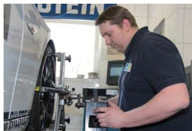
**12** На последнем этапе работ всегда следует проверить и настроить углы колёс. После чего, если установили амортизаторы с оригинальными характеристиками,
