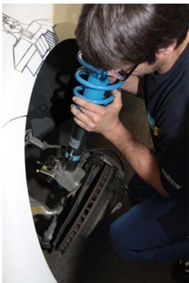
**9** При установке нового амортизатора поможет распорный инструмент. Если расширить поворотный кулак этим инструментом, устанавливать амортизатор будет значительно удобнее, так как это можно будет делать сразу двумя руками.
