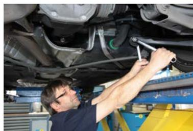
**11** При установке тюнинговых амортизаторов, уменьшающих дорожный просвет, особенно важно избежать перезатягивания. Поэтому всегда следует соблюдать правило
