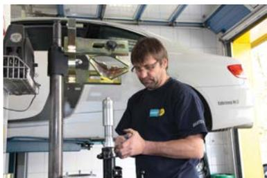
**7** Амортизаторы на дорожных автомобилях часто снабжены отбойной пружиной, которая ограничивает ход отбоя. Тут обязательно следует использовать специальный инструмент, чтобы потом отпустить гайку штока и правильно установить натяжитель пружины.
