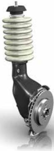
Модуль амортизационной стойки шасси из легких материалов по весу в два раза легче стандартной амортизационной стойки из стали.
