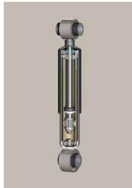
Для создания заднего моста с подвеской колес на продольных рычагах инженеры ZF использовали сталь и композиционные материалы на углеродоволокнистой основе. Идеальным дополнением такой оси являются амортизаторы облегченной конструкции от ZF, которые после проведения работ по оптимизации стали на 25 процентов легче стандартного демпфера благодаря использованию алюминия в комбинации с опорой амортизатора с пластмассовым покрытием. ▼
