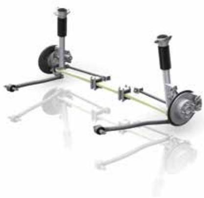
Облегченная конструкция поперечной листовой рессоры ZF (выделена зеленым) выполняет как поворот колеса, так и функции амортизации (наклон и весовую стабилизацию).
