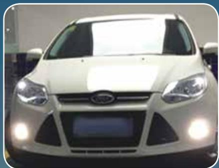
миссия завершена. При включении ПТФ работают соответствующие сегменты в LEDFOG101 (причем они имеют приоритет включения перед ДХО), при включении поворотов загораются под углом 45 градусов дополнительные секции подсветки ПТФ в нужном направлении, вне зависимости включены основные ПТФ или нет. А при включении “аварийки” ДХО начинают моргать в ее режиме.
