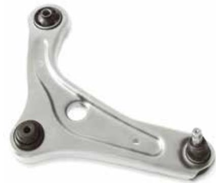
Облегчение конструкции благодаря функциональной интеграции: новая модель поперечного рычага подвески SMiCA (Sheet Metal integrated Control Arm – интегрированный рычаг управления из листового металла) выпускается при полном отсутствии швов и винтовых соединений.
